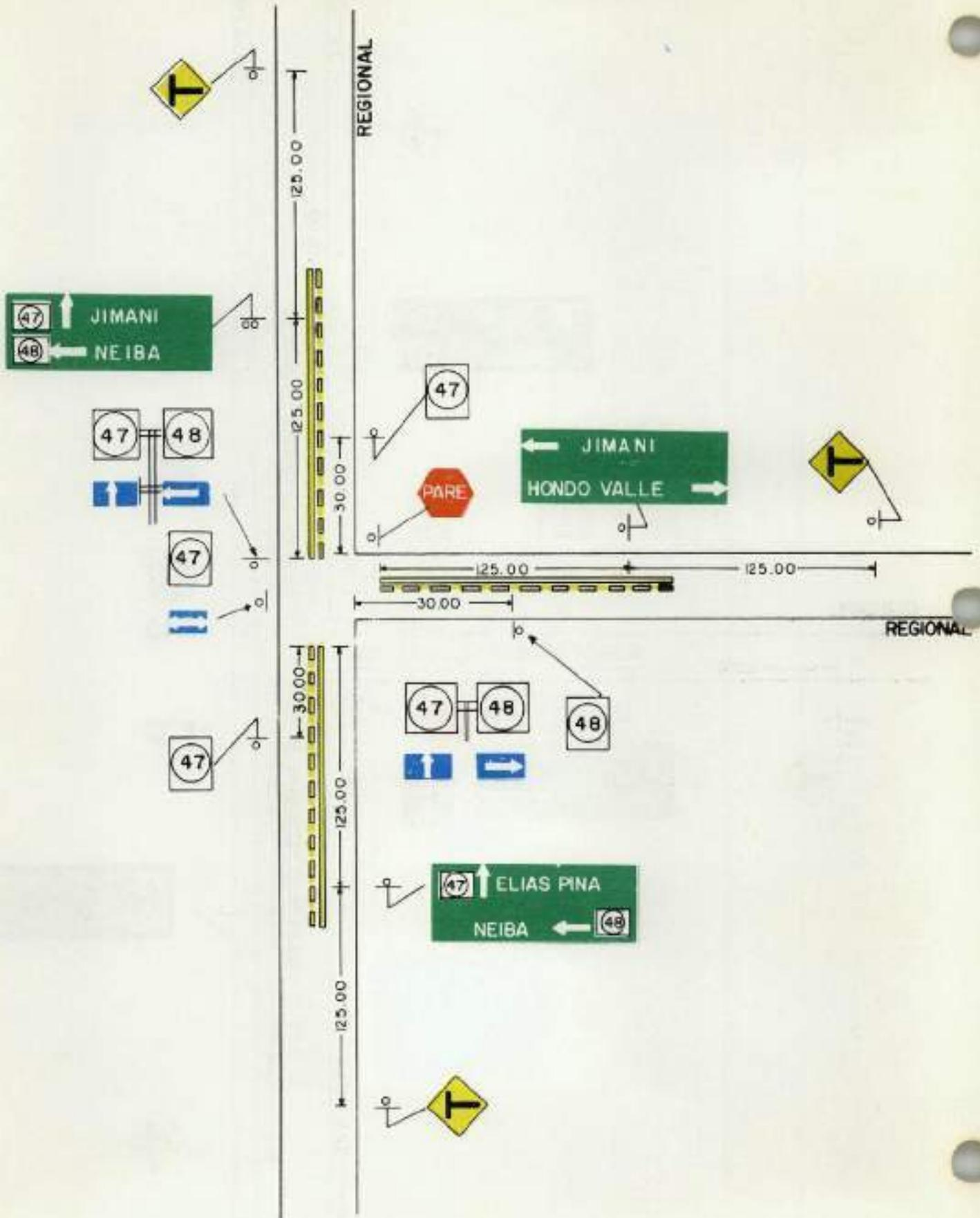
FIGURA 2.8 — Señalamiento típico para intersecciones de una carretera regional con una local.
